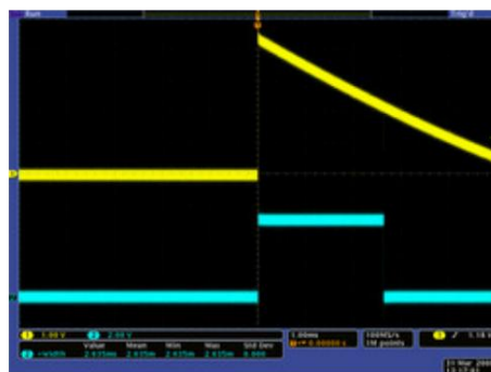
Salida QTR-1RC (amarilla) cuando está 1/8" por encima de una línea negra y temporización del microcontrolador de esa salida (azul).
