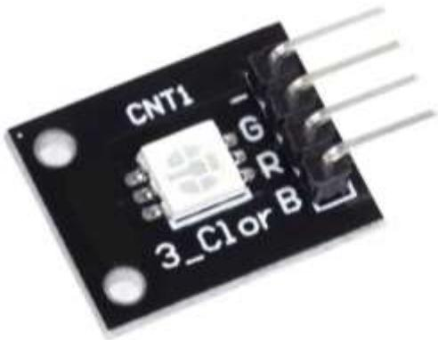
**Descripción:** Módulo LED SMD RGB, consiste en un LED capaz de crear cualquier color utilizando RGB, tiene una entrada de voltaje PWM con tres pines. Los colores primarios (rojo / verde / azul) son usados con el fin de lograr el efecto de mezclar colores y obtener cualquier color deseado. Con este módulo se pueden crear efectos de color muy llamativos.
