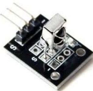
**Descripción:** Este es el nuevo y ultra delgado 38k infrarrojo para control remoto universal, utilizado en la codificación NEC, principalmente en vehículos con MP3, marco de fotos digital, iluminación equipada y otras aplicaciones. Debido a que es no lineal es de fácil uso y aprendizaje de parte del usuario.
