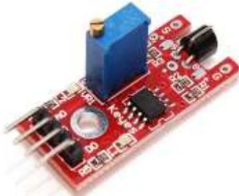
**Descripción:** Módulo sensor metálico táctil, cuenta con un LED que deberá conectarse con un simple circuito al pin número 13 del Arduino. Cuando el sensor detecta un el toque de una persona el LED conectado deberá encender, de lo contrario el LED permanecerá apagado.
