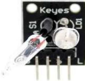
**Descripción:** Este módulo tiene dos partes - un LED y un interruptor de inclinación de mercurio.
