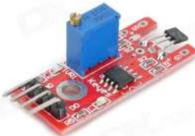
**Descripción:** Este módulo cuenta con un sensor de campo magnético y un LED el cual deberá conectarse al pin 13 del Arduino, al detectar un campo el LED se encenderá y de esta manera generara una alerta. De no detectar ningún campo el LED permanecerá apagado.
