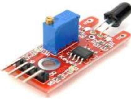
**Descripción:** El sensor funciona entre las longitudes de onda infrarroja 760 nm a 1100 nm, es más sensible utilizando dos salidas a 60 grados. Salida analógica: señal analógica de tensión conectada a una resistencia térmica. Señal digital: cuando la temperatura alcanza ciertos umbrales la salida del sensor sube y baja en conjunto con la temperatura, esta señal a la salida es variable con el potenciómetro.
