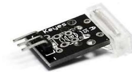
**Descripción:** El modulo sensor de golpe debe ser conectado a un circuito muy simple que constara de un LED conectado al PIN 13 del Arduino, el cual, parpadeará en el momento que el modulo detecte un golpe, de lo contrario el LED permanecerá encendido.
