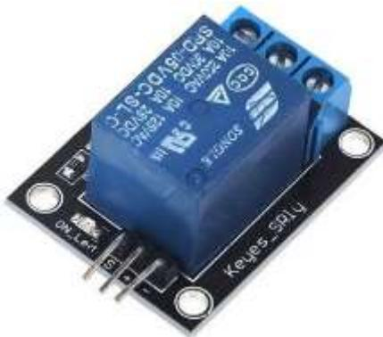
**Descripción:** Con este módulo, el cual tiene adicionado un relevador podrás conectar circuitos de 240V AC o 28V DC. Los relevadores son utilizados como sistemas de control y swicheo en alarmas, juguetes y muchas otras aplicaciones. Comúnmente son usados en circuitos de control automático con una pequeña corriente de control y una gran corriente de operación.
