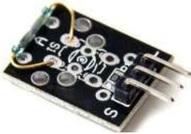
**Descripción:** Una lámina magnética es un sensor que se encuentra comúnmente abierto y al detectar un campo magnético se cierra, permitiendo el paso del voltaje.
