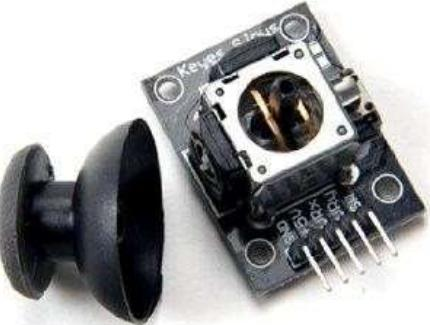
**Descripción:** Joystick similar al incluido en el juego PS2, el joystick por un potenciómetro en cada eje que es variado con los movimientos, además, incluye un botón Z que es activado al presionar el joystick.
