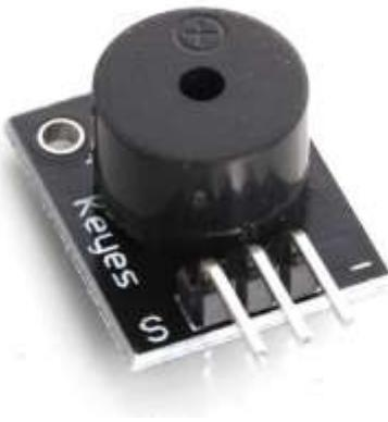
**Descripción:** Los buzzers tienen un rol muy importante en la estructura de transductores electrónicos, son ampliamente utilizados en computadoras, impresoras, fotocopiadoras, alarmas, juguetes electrónicos, teléfonos, timers, productos de electrónica para equipos de sonido y muchos más.
