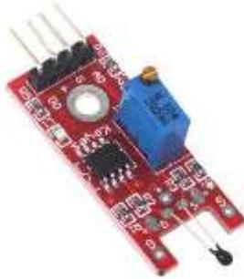
**Descripción:** Módulo de temperatura digital, cuenta con un LED que se conecta al PIN 13 del Arduino. El sensor de temperatura digital es activado al detectar una variación en la temperatura, cuando esto sucede el LED se enciende, de lo contrario el LED permanecerá apagado.
