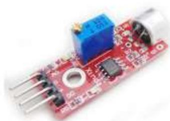
**Descripción:** Para la detección de sonido el módulo tiene dos salidas: AO, salida analógica, la señal de tensión de salida en tiempo real del micrófono y DO, cuando la intensidad del sonido alcanza un cierto umbral, la salida de señal de alta y baja. El umbral de sensibilidad se puede ajustar mediante el potenciómetro en el sensor.
