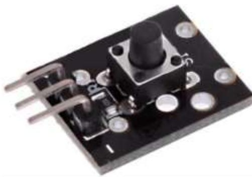
**Descripción:** Este módulo tiene integrado un interruptor común, se muestra un ejemplo en el cual, al presionar el botón se encenderá el LED conectado al PIN 13 del Arduino.
