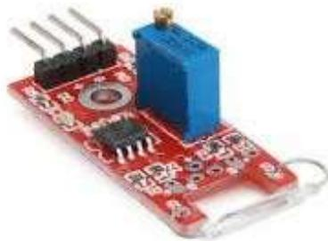
**Descripción:** Este módulo cuenta con una lámina detectora de campos magnéticos (Reed Switch) y un LED el cual deberá conectarse al pin 13 del Arduino, al detectar un campo el LED se encenderá y de esta manera generara una alerta. De no detectar ningún campo el LED permanecerá apagado.
