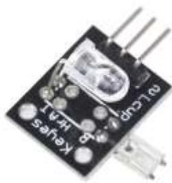
**Descripción:** Este módulo utiliza un LED infrarrojo brillante y un fototransistor para detectar el pulso del dedo, el LED enciende en rojo con cada pulso. Monitor de pulso funciona de la siguiente manera: El LED genera la luz por un lado del dedo, y el fototransistor en el otro lado del dedo, el fototransistor es utilizado para obtener el flujo emitido, cuando el pulso de la presión arterial en el dedo varía la resistencia del fototransistor cambia ligeramente.
