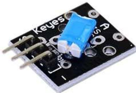
**Descripción:** Módulo interruptor de inclinación, este sensor envía un pulso al detectar una inclinación. Se mostrara un código ejemplo en el cual será necesario construir un circuito simple que contara de un LED, dicho LED encenderá al percibirse una inclinación por parte del sensor, de no detectar nada, el LED permanecerá apagado.
