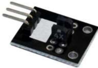
**Descripción:** Módulo foto-interruptor que funciona con Arduino. Si el sensor es accionado entonces el LED se enciende.
