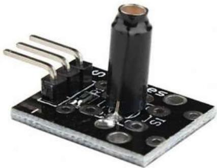
**Descripción:** Este módulo sensor de vibraciones funciona como un switch, al detectar una vibración cierra un circuito lo que genera que el usuario pueda detectar los movimientos. El modulo debe conectarse el PIN 10 del Arduino. Cuando detecta una vibración se enciende el LED conectado al PIN 13.
