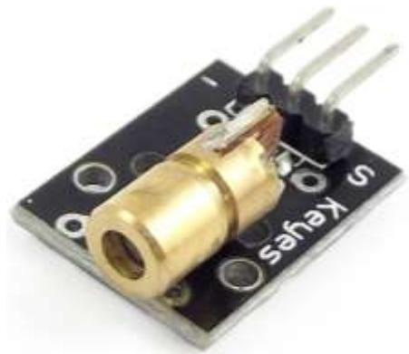
**Descripción:**Este módulo tiene integrado un transmisor laser y una interfaz digital, además cuenta con un LED incorporado.
