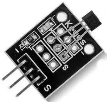
**Descripción:** Este sensor mide un campo magnético. Si existe la presencia de un campo magnético se creara una señal en alto. En este ejemplo, el LED de la placa Arduino (pin 13) se enciende cuando la señal del sensor es alta. También el LED propio del módulo se enciende cuando la señal esta en alto.
