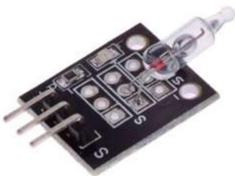
**Descripción:** El módulo óptico de mercurio es utilizado para detectar inclinación y encendiendo un LED informa al usuario, este sensor es el precursor de los ahora llamados acelerómetros utilizados en los dispositivos móviles como celulares inteligentes y tabletas.
