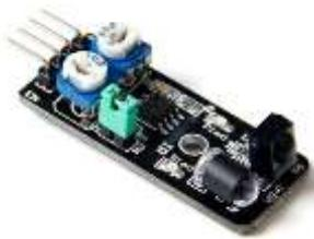
**Descripción:** Sensor de evitación de obstáculos por infrarrojo, está diseñado para la elaboración robots de ruedas evasores de obstáculos. Este sensor de luz ambiental es adaptable, de alta precisión, que tiene un par de infrarrojos de transmisión y recepción, el infrarrojo transmisor emite una cierta frecuencia, al detectar la dirección de un obstáculo (reflector), el tubo receptor de infrarrojos recibe el reflejo, cuando esto sucede el indicador LED enciende, a través del circuito.
