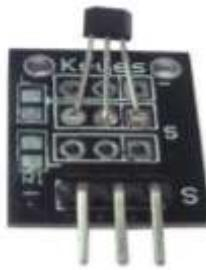
**Descripción:** Módulo sensor magnético analógico, se debe construir un circuito simple con un LED para crear un campo magnético Makers. Cuando el sensor detecta un campo magnético el LED conectado deberá encender, de lo contrario el LED permanecerá apagado.
