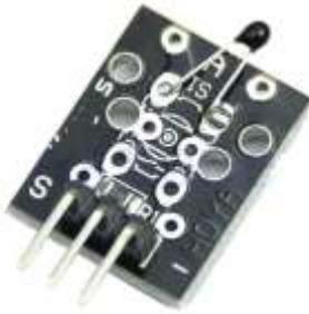
**Descripción:** El módulo contiene un termistor, censa en tiempo real la temperatura y varia sus valores internos, conectando al Arduino en sus pines analógicos es posible realizar un gran número de implementaciones, por ejemplo, alarma térmicas.
