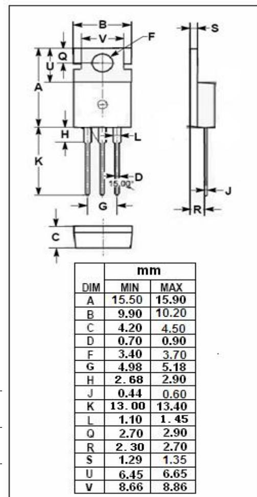
**isc N-Channel MOSFET Transistor****IRFB4310, IIRFB4310****ELECTRICAL CHARACTERISTICS** $T_c=25^\circ\text{C}$  unless otherwise specified
